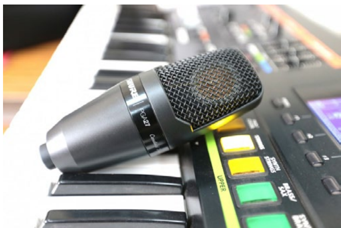
图 7 话筒近照,从这个角度可以看到镀金的大振膜
