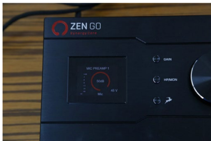
图12 那个羚羊键,并不像ZEN TOUR那样可以切换监听,它其实只是一个返回键而已。按住羚羊键不放,用大旋钮可以调节屏幕亮度。而且这个屏幕也不能触摸。
