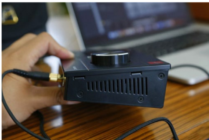
图7 金属机身，侧面的散热孔做工很不错。
