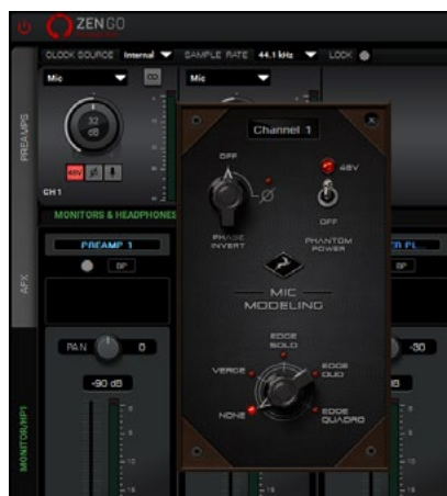
图22 点击小话筒按钮,还可以弹出更加详尽的话筒控制面板,而且可以配合羚羊的EDGE系列话筒来使用。关于EDGE话筒之前我们也曾经详细评测过,它可以模拟像U87之类各种经典话筒的声音。
