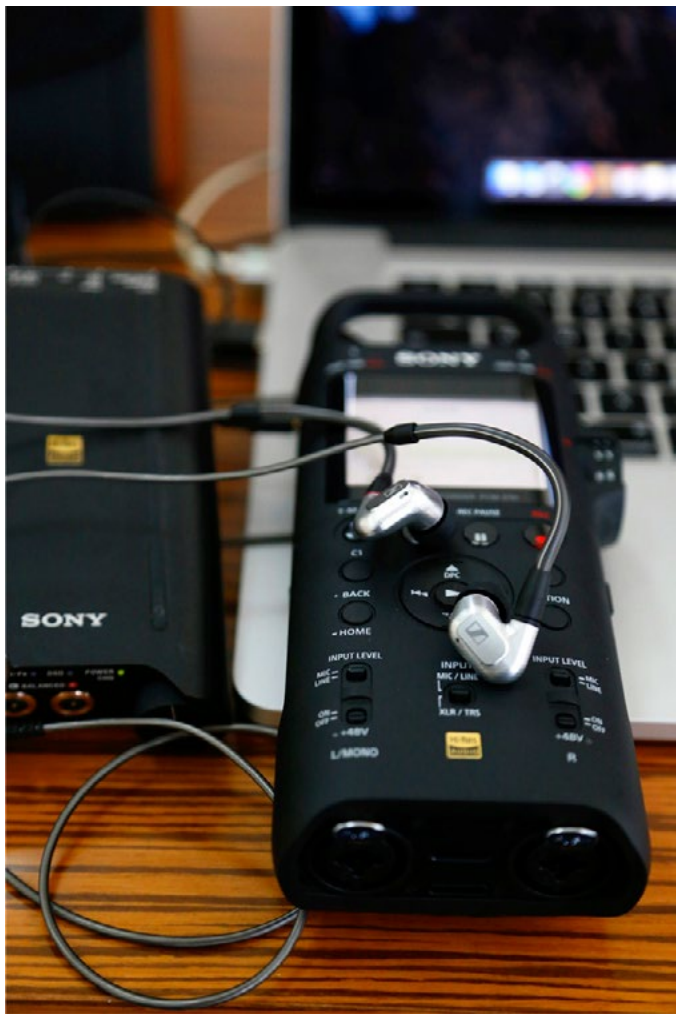
图11 索尼D10,其实这款录音笔我觉得声音还是不如D100的,入手它只是因为它有蓝牙和卡农输入口可以直接插电话筒并提供48V供电,所以这个机器我主要还是用来录音。仅作参考吧。
