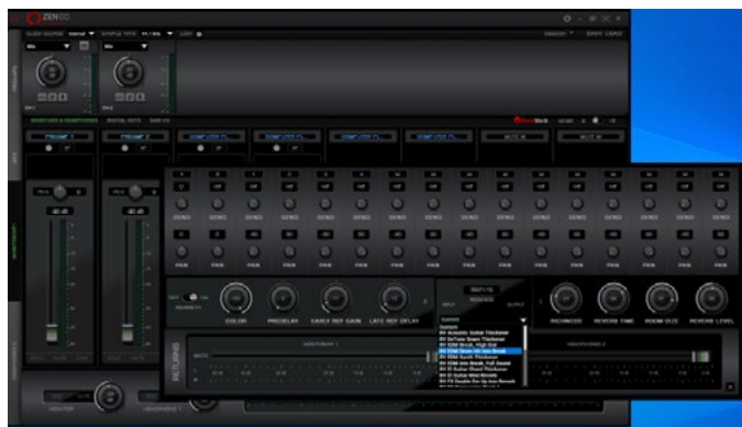
图26 自带的混响效果，同样也可以直接用在声卡的音频通道中，实现诸如听湿录干等返听功能，这也是很方便的。但如果它能像ZEN TOUR那样支持对讲就真的太方便了，可惜它没有。
