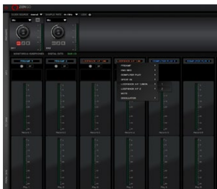
图27 ZEN GO也具备声音通道的路由调节功能，并且能够内录。如图所示我们可以看到它的所有声音通道都是可以自由进行发送的，而且它拥有LoopBack通道，这对通道就是用来内录的，你可以把总监听输出或者耳机输出的声音发送到LoopBack通道，然后在Cubase等软件中选择这对通道来录音，就能把电脑上其他播放器软件或是网页上的声音录进Cubase了。
