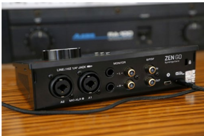
图9 两个话放位于背面，都是多用的卡农口，能插卡农也能插大二芯大三芯，支持高阻乐器插入。
