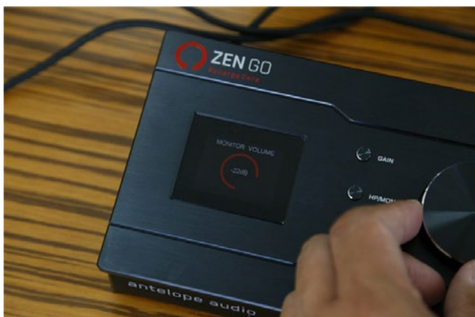
图11 大旋钮可以调节各项音量,也可以按下去进行选择。按面板上的GAIN键就是调节话放的增益,按HP/MON键就是调节耳机或音箱的总输出音量。
