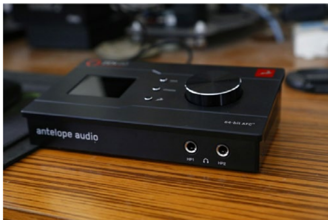
图8 两个耳机插孔，而且这两个耳放的音量是可以独立分开控制的，值得称赞！
