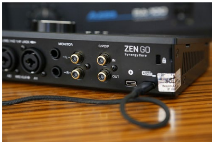
图10 两对输出，TRS口和RCA口，但通道是同一对，声音一样。无法分开调节，也无法进行切换。那个画着闪电的接口并不是雷电口，而只是一个外接电源口，在连接移动设备的时候，可以插外置电源或者充电宝。
