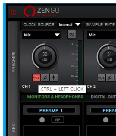
图20 两个话放的增益、48V幻相供电以及反相开关都可以在这里操作。
