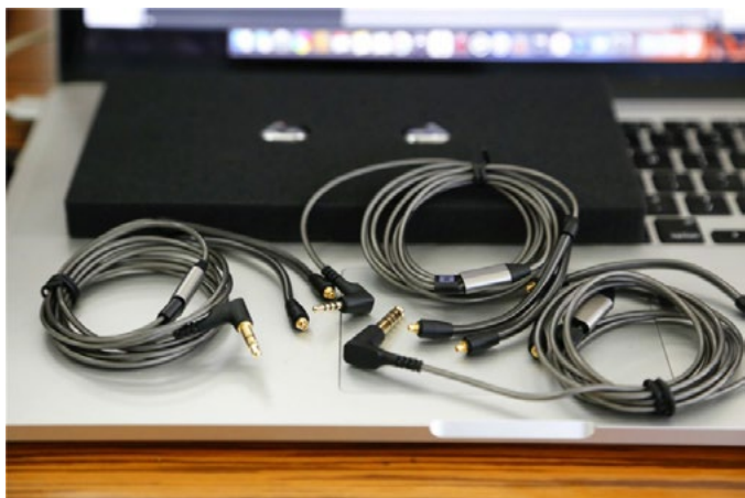
图5 三根不同尺寸插头的线, 其中包括一根普通3.5线和2.5/4.4两根平衡线。注意它们的插头是四节头的, 而不是普通3.5的三节头。个人感觉如果再提供一根直插的短线就好了, 对于一些带线控的老设备或是比较小的领夹式播放器就更友好一些。当然了这种耳机的定位就是专用的播放器, 所以这样配备线材也是无可厚非。
