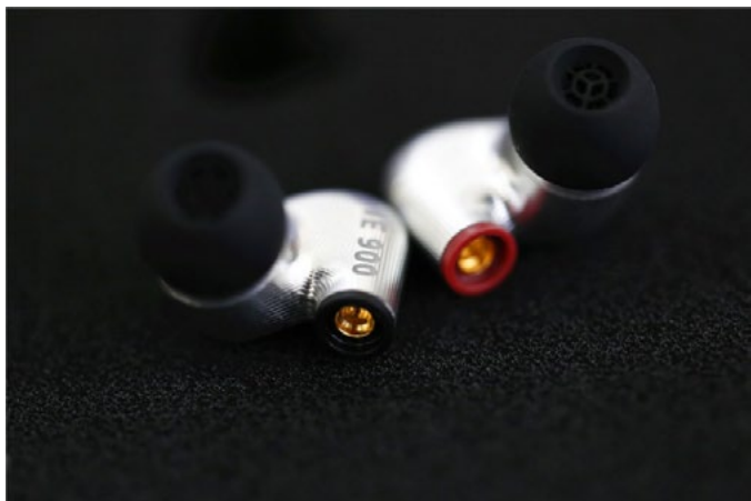
图7 耳机细节。整个外壳都是金属铝做成的, 有类似拉丝的铣削纹路, 非常有质感。耳塞接口处红圈是R, 黑圈是L, 这个是通用的惯例很好分辨, 另外在左耳的耳机上还有一个小突起可以辅助辨别。
