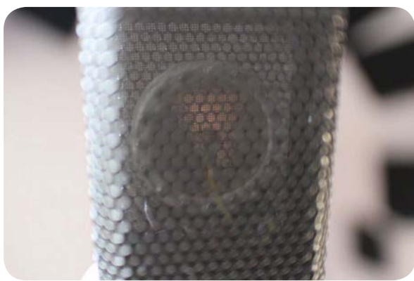
图05 第二层细网以及双振膜的电容话筒头
