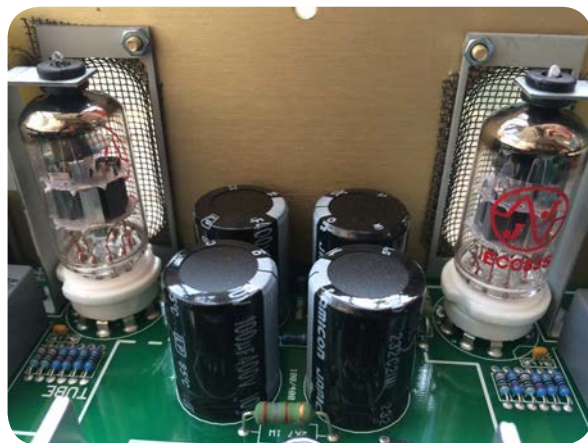
图25 两只电子管和四只大电容
