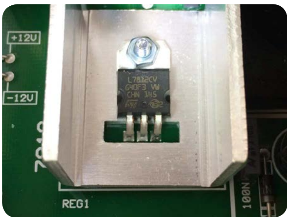
图26 金属散热片上的电源稳压芯片
