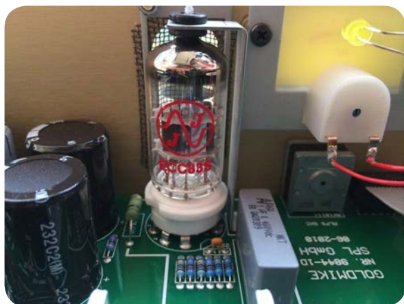
图23 ECC83SE电子管特写，顶端银色的消气涂层很亮
