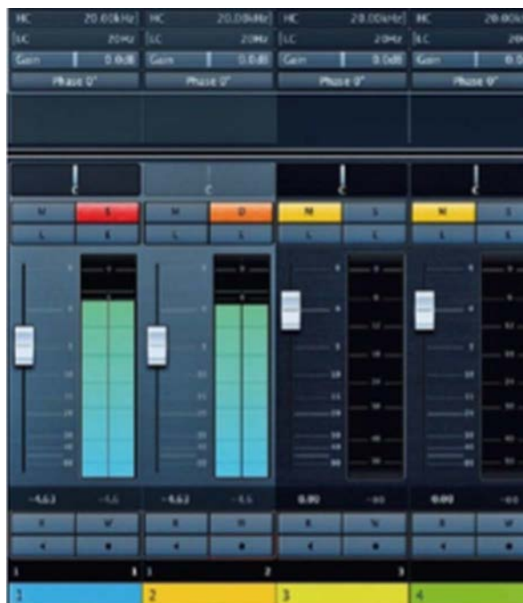
图05 当其他轨道独奏时，使用Solo Defeat或Solo Safe防止通道信号静音
