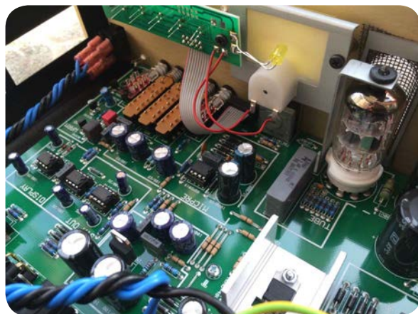
图29 电路板左侧。表头后面有一个LED灯照明
