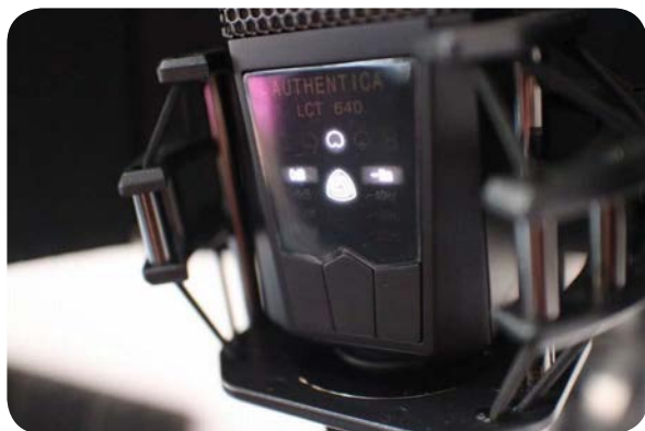
图09 话筒正面有带背光的操作菜单，提供了多种填补、滤波和指向选择
