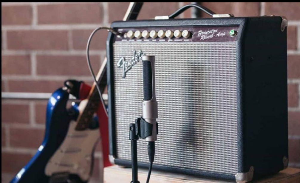
图 3 使用 Nuvo N22 铝带麦克风录制电吉他音箱。在使用电容或铝带麦克风时，需要将振膜对准音箱的振膜。在此基础上，你可以根据下文的技巧来微调麦克风的位置或角度。（图片来源：Naomi Feller）
