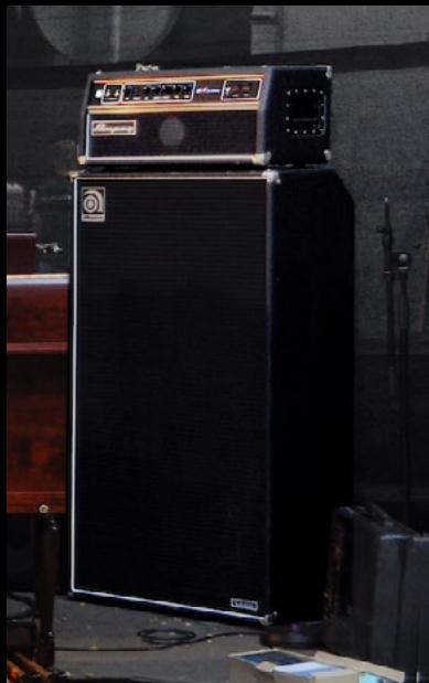
图 2 许多声卡的麦克风前置放大器可以响应低水平信号，这样你就可以调低贝斯音箱的音量，以麦克风对准音箱的传统方式录制贝斯。图为由 Ampeg 推出的 SVT Classic 电子管贝斯音箱套装。（图片来源：Produce Like A Pro）
