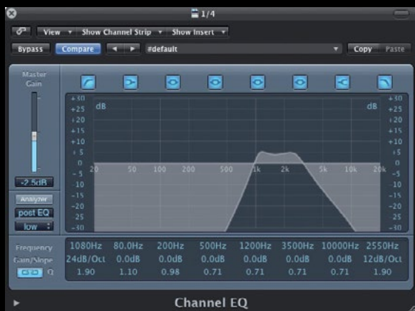
图4 “电话均衡”可置于延迟效果之前或之后，以此区别人声与回声。（图片来源：本文原作者）
