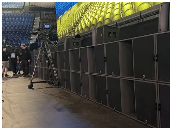
图 9 堆叠在地面的次低频音箱阵列 (sub array)。(图片来源：Colin Pink)
