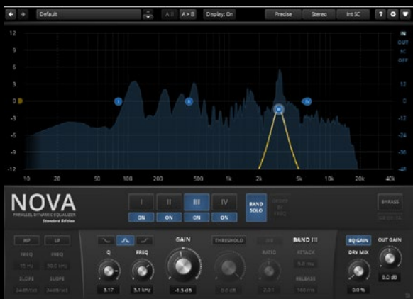
图 6 使用 TDR Nova 的“Band Solo”模式来查找“齿音带”。
