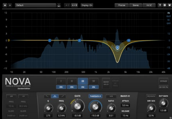
图 7 本例中使用的 De-Ess 参数。回放过程中，插件会直观显示输入信号电平（Threshold 旋钮的灯条），以及动态 EQ 削弱的电平（Gain 旋钮的灯条，以及频谱图中的金色曲线）。
